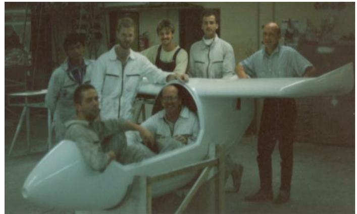
Der STRATOS I, IIe und 300 K waren jeweils einsitzige Ultraleichtflugzeuge in der Kunststoff-Faserverbundbauweise. Durch den freitragenden Flügel, der mit einer Gleitzahl von ca. 23 überzeugte, wurden für damalige Verhältnisse Segelflugleistungen erreicht, die selbst reine Segelflugpiloten überzeuften.
